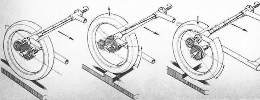
Auch bei Unebenheiten bleibt das Seitenwagenrad stets „bodenhaftend“, was durch einen Schwingarm, der das Seitenwagenrad trägt, ermöglicht wird. Mit der Antriebswelle stets kraftschlüssig verbunden, schwingt das angetriebene Seitenwagenrad auf bzw. ab, wodurch alle Stöße der Bodenunebenheiten aufgenommen werden, ohne sie auf den Seitenwagenrahmen zu übertragen.
